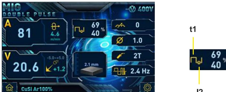
Otáčením pravým ENKODEREM nastavujete v synergickém režimu velikost špičkového svařovacího proudu ( $I_1$ ) např. na obrázku je nastaveno 81A. Současně jsou pro nastavený proud na displeji zobrazovány synergické hodnoty napětí, tloušťky materiálu (2,1 mm) a rychlosti podávání drátu (4,6 m/min.).
