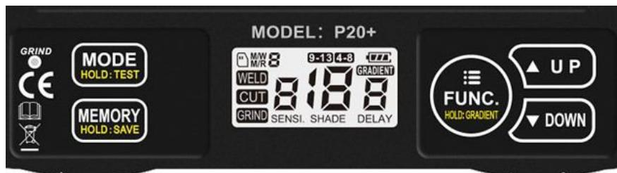
Režim broušení lze také aktivovat a deaktivovat dlouhým stiskem vnějšího bočního tlačítka. V režimu broušení **GRIND** je funkce ztmavnutí vypnutá. Během této doby má LCD průzor nejsvětlejší stav DIN3, což pomáhá získat jasnější pohled vedle maximální ochrany.
